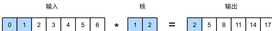
图15.3.2: 一维互相关运算。阴影部分是第一个输出元素以及用于输出计算的输入和核张量元素： 0 \times 1 + 1 \times 2 = 2
